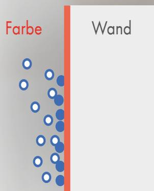
In der Raumluft enthaltene Feuchtigkeit kann nicht durch die dichte Farbschicht diffundieren. Sie kondensiert an der Wandoberfläche, was zu Schimmelbefall führen kann.
