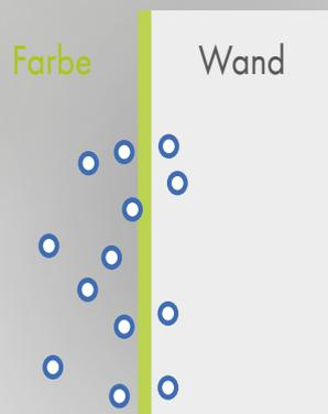
In der Raumluft enthaltene Feuchtigkeit kann ungehindert durch die offenporige Farbschicht diffundieren. Die Raumfeuchte wird reguliert, die Wandoberfläche bleibt trocken.
